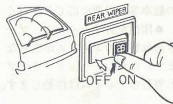
キー スイッチが ON 又は ACC 位置のとき、スイッチのマーク側Iを押している間、ウオッシャー液が噴出します。スイッチを押し込むとワイパーが作動します。
