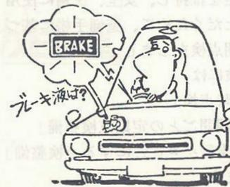
ブレーキ液がないとブレーキが効きません。走行中、ブレーキ液が少なくなるとブレーキ警告灯が点灯して運転者に知らせます。（13ページ ブレーキ警告灯の項参照）
