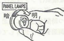
ライトコンビネーションスイッチが1段目のとき、このノブを回すと計器盤の照明の明るさが調節できます。
