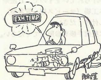
排気ガスは触媒や各種の浄化装置を用いて浄化しています。浄化装置などが万一、故障しますと触媒温度が異常に高くなり、排気温度警告灯が点灯して、運転者に知らせます。（12ページ排気温度警告灯の項参照）
