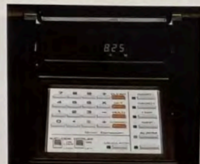
センターコンソールに装備した表示部
